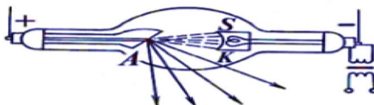
2 -rasm. Elektron rentgen trubkasining sxemasi tasvirlangan.
